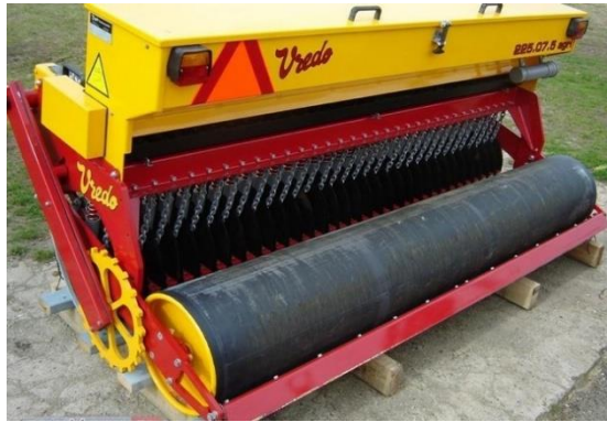
Sämaschine für die Direktsaat bei der Nachsaat.
