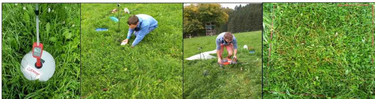
Rycina 2. Pomiar wysokości roślinności za pomocą elektronicznego miernika talerzowego, a także zbiór biomasy w wyznaczonym obszarze
