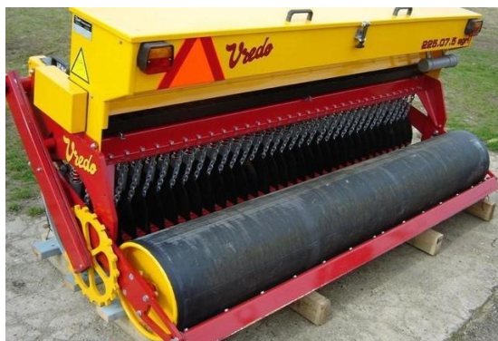
Siewnik wykorzystany do podsiewu bezpośredniego
