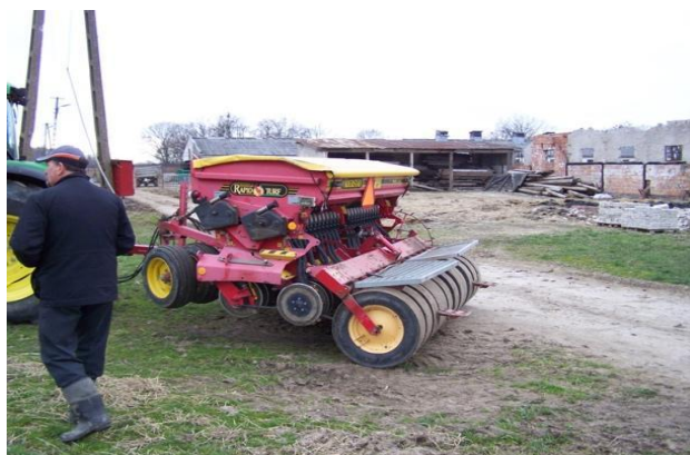
Siewnik do siewu bezpośredniego Väderstad Rapid przygotowany do pracy (fot. K. Terlikowska)
