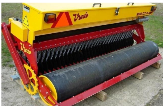
Sembradora utilizada para la resiembra directa
